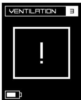
Message «défaillance de la ventilation»
