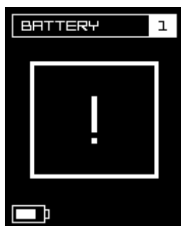
Aviso "Batería defectuosa"
