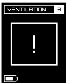
Aviso "Ventilación defectuosa"
