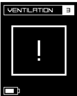
Meldung "Lüftung defekt"
